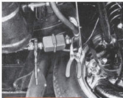
Benzinfilter Volvo 241724, anvendt modelår
