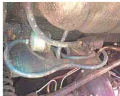
Benzinfilter Volvo 243214 mellem pumpe og motor
