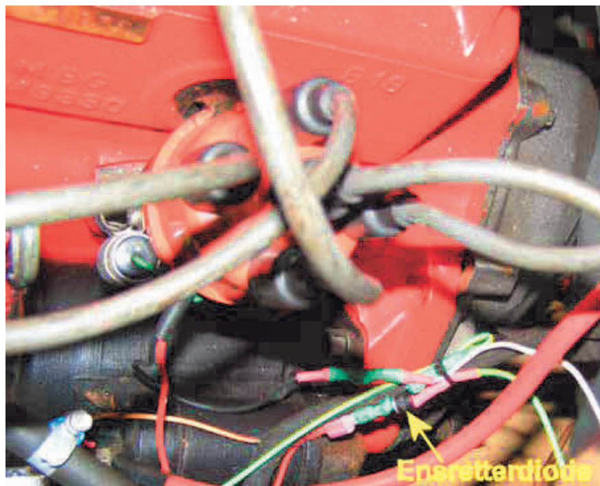
Den modificerede strømfordeler monteret på motorblokken
