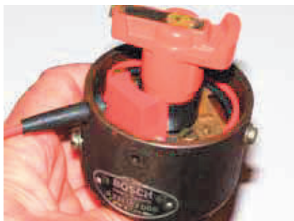
Strømfordeler med genmonteret rotor
