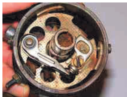
Strømfordeler med og uden rotor
