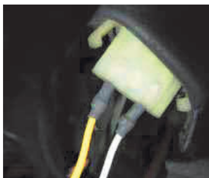
Gul og hvid ledning på indsprøjtningsstik
