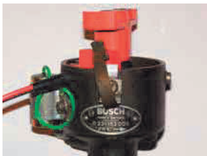
Så er strømfordeleren klar til genmontering
