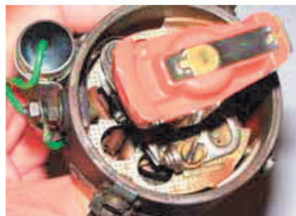
Strømfordeler med og uden rotor
