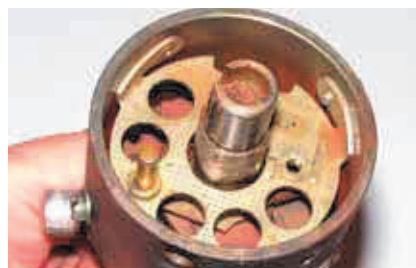
Her er platinsættet og kondensatoren demonteret
