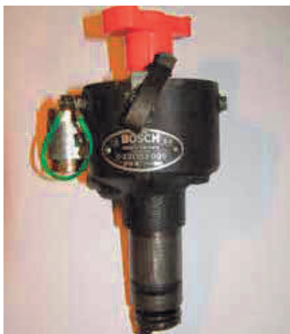
Strømfordeleren demonteret fra motoren
