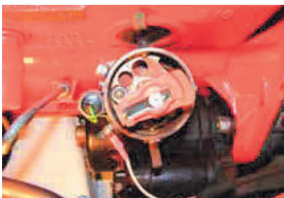
Original Bosch strømfordeler på en B18 motor
